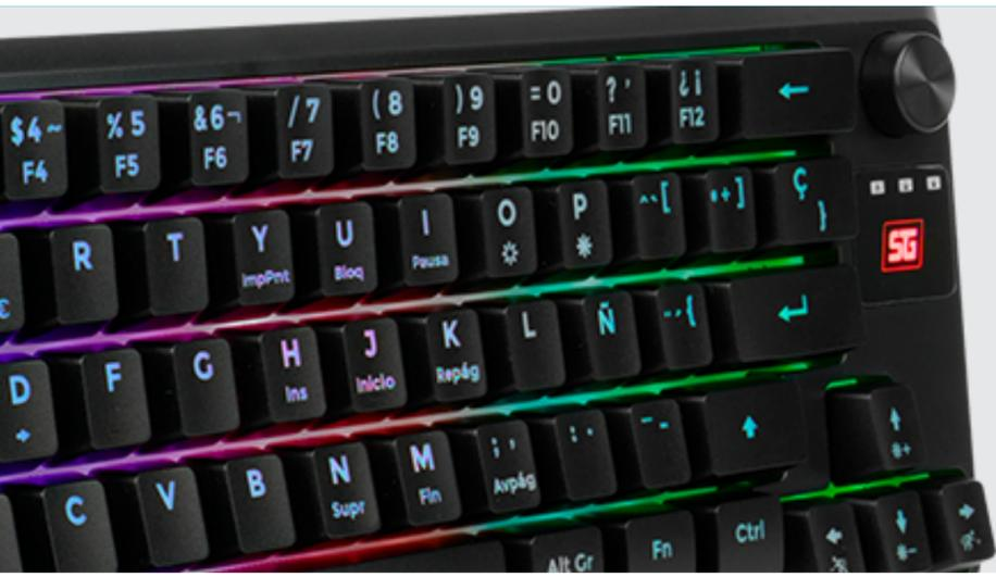
**RGB.** Descubre los 7 modos de iluminación RGB de este teclado y regula fácilmente su brillo y velocidad con la rueda integrada que además te permite ajustar el volumen del audio de tu computadora.
